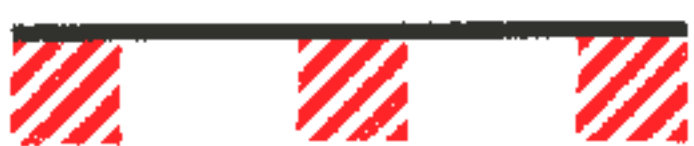
Обозначение гибких связующих звеньев при буксировке механических транспортных средств
